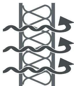
Développé spécifiquement pour l'isolation thermique des murs par l'extérieur, **Triso-Bardage bénéficie d'un écran HPV et d'une conception lui permettant l'évacuation de la vapeur d'eau**, pour prémunir les risques de condensation.
