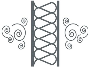
**L'isolant alvéolaire Triso-Bardage est complètement étanche à l'air selon la norme EN 12114, sans rajout nécessaire de membrane d'étanchéité. L'étanchéité à l'air est un critère essentiel pris en compte dans la Réglementation Thermique 2012. Sans traitement de l'étanchéité à l'air de part et d'autre de l'isolant, la perte d'efficacité thermique peut atteindre 80%\*.**
