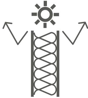
L'isolant Triso-Bardage assure une protection très efficace contre la chaleur en été, en plus de ses performances thermiques en hiver. Ses films réflecteurs internes renvoient jusqu'à 95% des rayonnements thermiques infrarouges, limitant le réchauffement de la paroi et la pénétration de chaleur à l'intérieur de l'habitat. Un critère important en terme de confort thermique et de réduction de consommation énergétique liée à l'utilisation de la climatisation.
