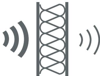
Matériau souple et absorbant, Triso-Bardage offre une bonne protection phonique. **Sa structure alvéolaire fonctionne comme un réseau de cellules fermées étanches à l'air** : un critère important sachant que le bruit se propage par le support de l'air (300 m/s). Cette conception exclusive contribue au confort phonique dans l'habitat.
