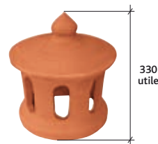
Lanterne Ø 200 utile (section d'aération : 300 cm²) Réf. 1012
