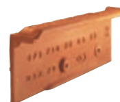
Rive individuelle gauche à recouvrement à pureau variable Marseille (2,7 au ml au pureau de 370 mm) Réf. 208.49
