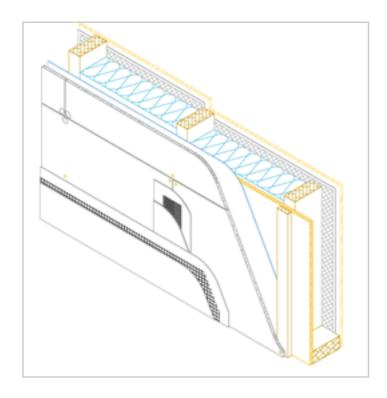
Mur à cavité fermée : avec lame d'air de 1 cm minimum. Les plaques Aquapanel® Outdoor sont fixées sur des tasseaux bois verticaux de 60 mm de largeur au moins. Si la mise en oeuvre des plaques Aquapanel® Outdoor n'est pas réalisée immédiatement, il est nécessaire de mettre en place un pare-pluie pour protéger le panneau extérieur des intempéries en phase chantier.
