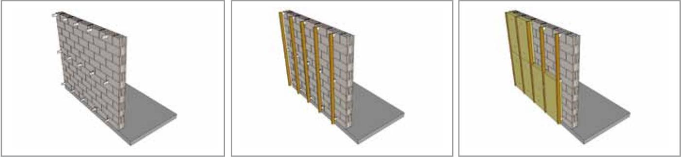
Les panneaux doivent être posés horizontalement ou verticalement à joints décalés bien jointifs et maintenus par 1 à 4 chevilles pour isolant par panneau (cheville avec rondelle de diamètre 80 mm).
