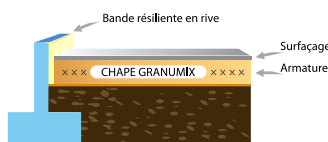
Dalle isolante sur terre plein
