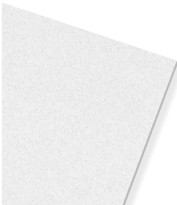
■ Dalle de plafond issue de la nouvelle génération de laine minérale bio-soluble, contenant de l'argile et de l'amidon, et lui conférant des caractéristiques mécaniques et acoustiques de tout premier ordre. Le voile positionné sur la surface lui permet de conserver un aspect lisse et blanc tout en offrant de bonnes performances acoustiques.
