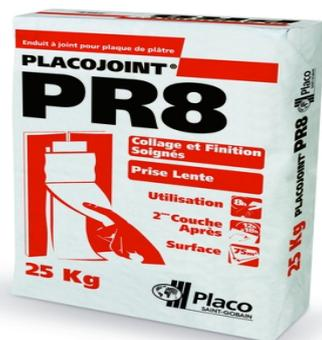
Enduit poudre à prise lente (8 heures) pour le jointoiment avec bande des plaques de plâtre permettant un redoublement des joints dans les 12 heures, indépendamment des conditions climatiques.
