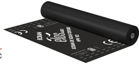
La pose de l'écran directement au contact de l'isolant permet le recouvrement du faitage. Ce type constructif assure une performance thermique optimisée de l'isolant. L'emploi d'un pare-vapeur indépendant est nécessaire du côté intérieur de la paroi.
